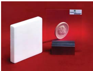
Traditionell weiße Keramik wird durchsichtig durch Submikrometer- und Nanotechnologie.
