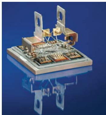
Abb. 2: Leistungselektronisches Testmodul (Bodenplatte gefertigt aus einem metallischen Verbundwerkstoff)
