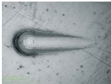
Abb. 2: Ritztest mit einer 50µm-Radius Diamantkugel in eine 5µm dicke Goldschicht. Die Normalkraft wurde von rechts nach links bis auf 2 N erhöht. Die Ritzlänge beträgt 140µm und die maximale Eindringtiefe 4,5µm. Das Bild wurde aus mehreren Bildern einer Fokusserie zusammengesetzt, um die nötige Schärfentiefe zu gewährleisten.
