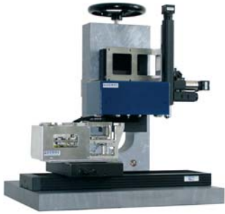
Abb. 1: Der Universelle Nanomechanische Tester – UNAT. Dieses Exemplar ist mit einem Rahmen aus Massiv-Silizium ausgestattet, der aber nicht zur Serienausführung gehört.
