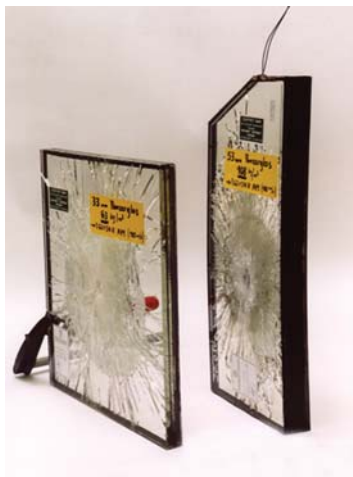
Keramik für den ballistischen Schutz – Durch Aufbringen weniger Millimeter dünner transparenter Keramik-Plättchen auf Panzerglas ist eine deutliche Gewichtsreduzierung bei höherer Sicherheit und bei gleicher Beschuss-Sicherheit erreichbar.
