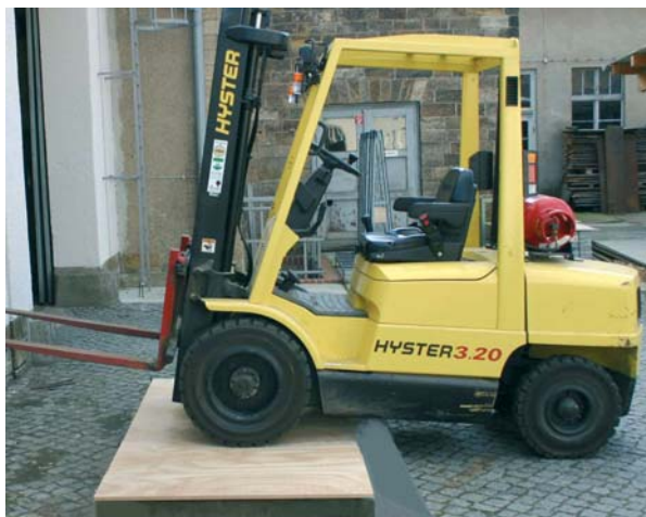
Im Belastungstest: Gabelstaplerrollen für Fahrzeugbodenplatten
