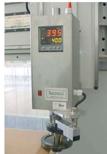
📷 Nachrüstadapter für ein CNC-Bearbeitungszentrum zum Thermoglätten von MDF-Bauteilen
