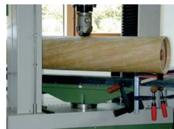
Biegeprüfung eines ausgesteiften drehwüchsigen Prüfkörpers in der 10-Tonnen-Pressen
