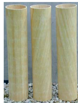
Prüfmodelle mit Faserverlauf parallel zur Stammachse (links), Rechtsdrehwuchs (Mitte) und Wechseldrehwuchs – innere Schicht Rechtsdrehwuchs, äußere Schicht Linksdrehwuchs – (rechts)
