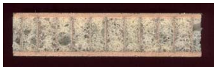
Querschnitt einer PU-verleimten Sandwichplatte mit Papierwabenkern und Furnierdeckschichten (Foto: Pursche)
