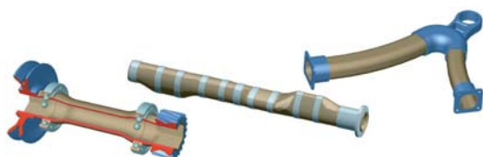
Bild 1: Beispiele textilverstärkter Hohlstrukturen mit ringförmig umgebenden metallischen Lasteinleitungselementen
