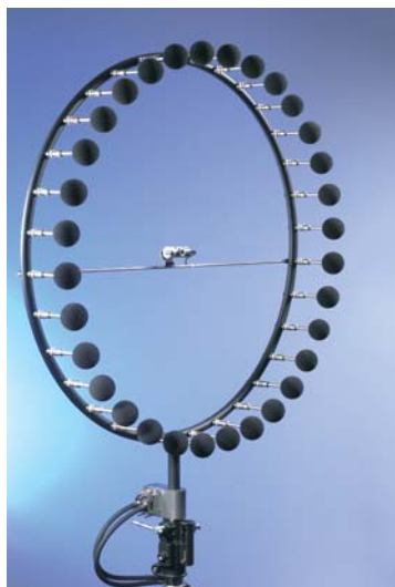
„Akustische Kamera“ AcoustiCam in Kooperation mit Sinus Messtechnik GmbH
