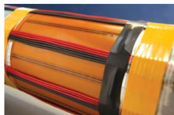
Abb. 3: Auf einer Gelenkwelle applizierte piezokeramische Folien Fotos: Fraunhofer IWU
