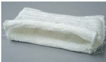
Flachgestrickte Abstandstrukturen für den Fußgängerschutz mit als Polfäden eingebundenen Monofilamenten (Detailansicht oben; Verwendung von Glasfilamentgarn in den Deckschichten) Foto: TUD/ITB
