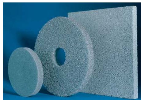
Abb. 1: Leichtbaustrukturen aus Stahlhohlkugeln und Stahlschaum
