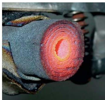
Schaum aus Ni-Basis-Legierung unter Hochtemperaturbelastung
