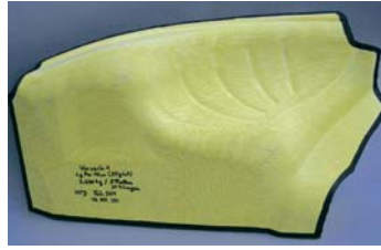
Pkw-Radlaufverkleidung für Beschussklassen B3/B4 (BMW E46, 3-er Reihe, 4-türig) aus einem biaxial verstärkten Mehrlagengestrick (Entwicklung des ITB mit der Automobil Technik-Design Forschung & Prototyp GmbH sowie der Teijin-Twaron GmbH) Foto: TUD/ITB
