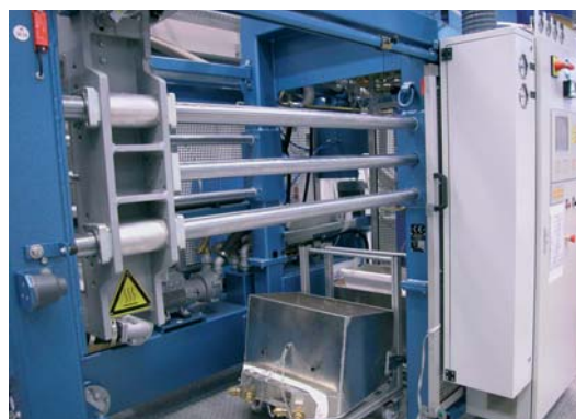
Abb. 6: Formteilautomat am Standort IFAM Dresden für die Herstellung komplexer Hohlkugelstrukturen Fotos: Fraunhofer IFAM Dresden
