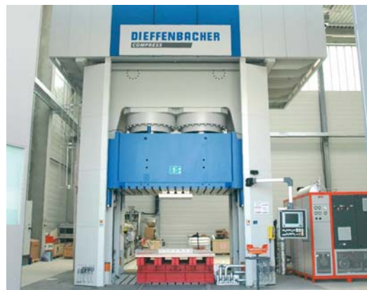
Abb. 1: 3000-t-Schnellhubpresse mit LFT-Extruder Foto: LZS GmbH
