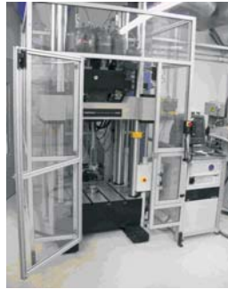
Bild 1: Servohydraulische Prüfmaschine für hochdynamische Werkstoff- und Komponententests
