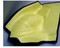
Pkw-Radlaufverkleidung für Beschussklassen B3/B4 (BMW E46, 3-er Reihe, 4-türig) aus einem biaxial verstärkten Mehrlagengestrick (Entwicklung des ITB mit der Automobil Technik-Design Forschung & Prototyp GmbH sowie der Teijin-Twaron GmbH) Foto: TUD/ITB
