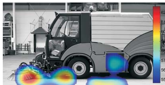
„Akustische Fotografie“ einer Reinigungsmaschine
