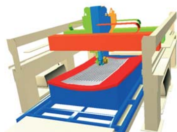
Abb. 3: Visualisierung einer Anlage zum Laserstrahlschweißen großformatiger Bauteile
