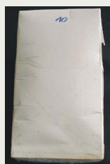
Modifizierte Packung nach zweimaligem Fallversuch
